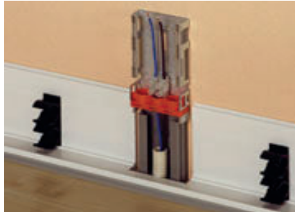
35. Kabelkanal monteres ved gulv med 2 skruer. Stikkontakt-underlaget monteres over kabelkanal med 2 skruer. Ledningerne samles med kronemuffer i stikkontakt underlagert for tilslutning i stikkontakten.
