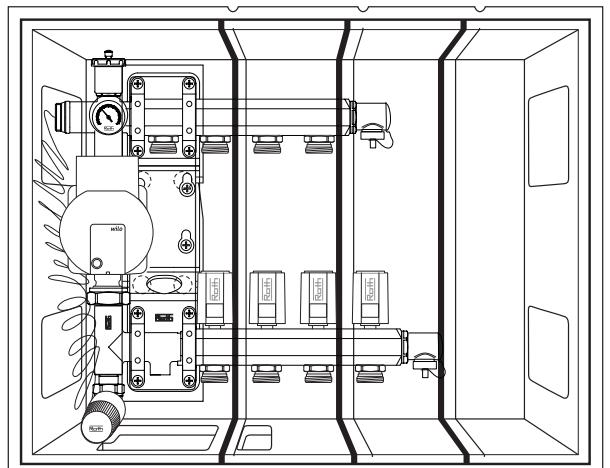
**(DK)** Afslut montering ved at trykke låget på. Isoleringen kan afkortes efter behov i skærerillerne markeret i fronten og hele vejen rundt om isoleringen. Enderne flyttes herefter ind for tilpasning.
