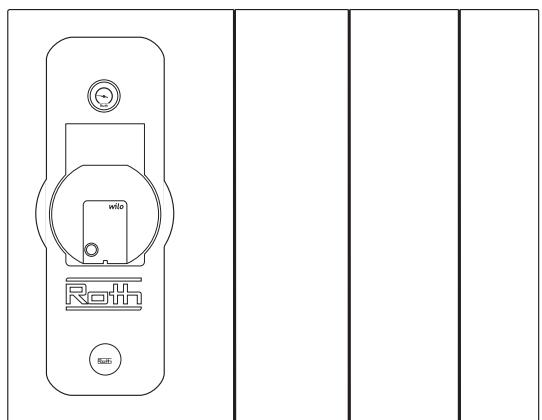
**(DK)** Isoleringen kan også spejlvendes hvis pumpen ønskes til højre. Vend isoleringen så den formstøbte ramme til shuntbeslaget er i højre siden, og afslut med at bytte om på top og bund plade så hullerne igen er placeret i bunden.
