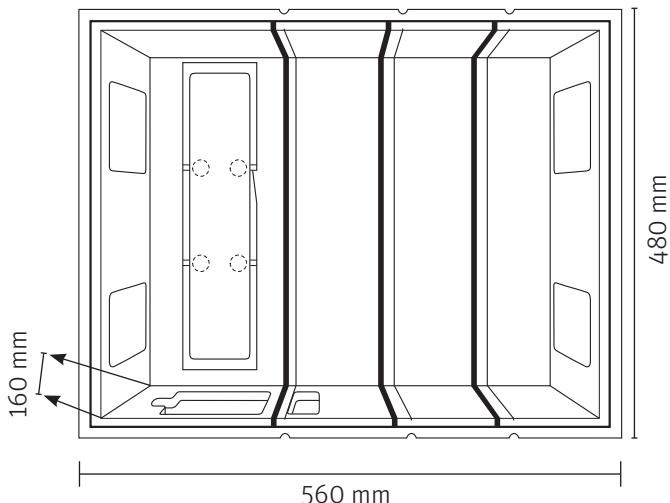
**(DK)** Shuntunitens beslag monteres i toppen af den formstøpte ramme. Kontroller at hullerne i beslaget er placeret vandret med slidserne i den formstøpte ramme. Herefter fastgøres ShuntUniten med skruer.
