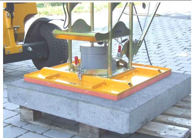
25. Gerät mit angesaugter Last nur ein wenig anheben (ca. 20-30 cm), dann Lastsicherungskette aus Kettenkasten entnehmen (↗) und unter dem angehobener Last durchwerfen(durchführen) ...
