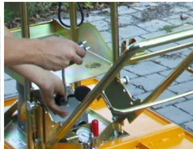
3. Anschließend Steckdose an Klemmbügel (vor Gebläseeinheit) befestigen.
