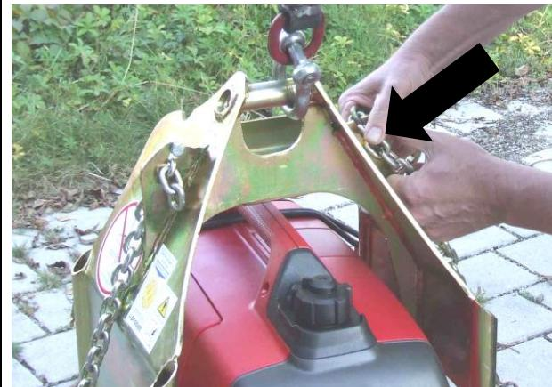
28. Lastsikkerhedskæden skal ligge stramt mod lasten således, at **lasten holdes fast af sikkerhedskæden** i tilfælde af vakuumsvigt (f.eks. betinget af strømsvigt).
