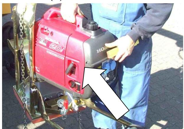
8. Korrekte Position des HONDA-Stromerzeugers am Gerät
