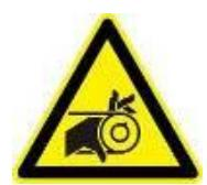
Handverletzungsgefahr durch Riemenantrieb.
