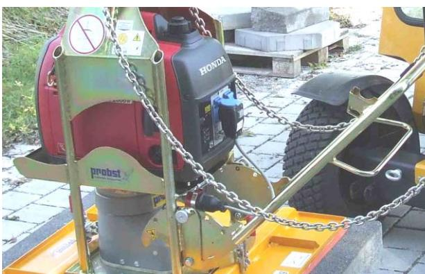
9. Træk gummibåndet igennem under transporthåndtaget (på generatoren) for at fastgøre generatoren, og hæng det på dertil beregnede kroge på enhedskonstruktionen (→)
