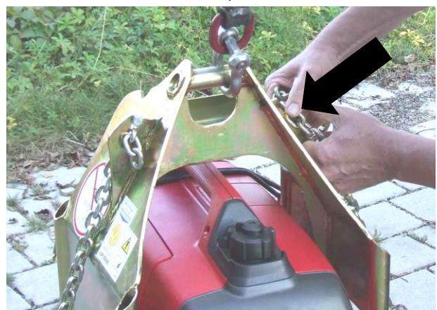
29. **Lastsicherungskette darf niemals locker unter der Last hängen, da sonst Last bei Vakuumausfall (z.B. bedingt durch Stromausfall)** herunterfallen kann.
