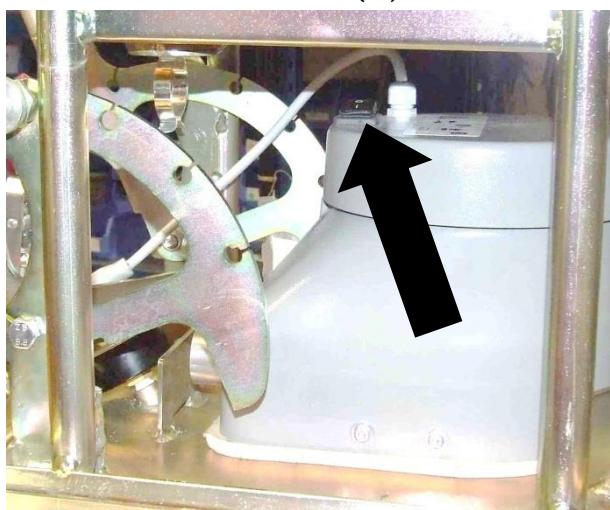
23. Das Ansaugen der Last (Steinplatte) sowie das Lösen erfolgt über den Kabelstecker (mit integriertem EIN/AUS-Schalter) am Handgriff (↗).
