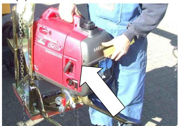
8. Korrekt placering af HONDA-generatoren på enheden
