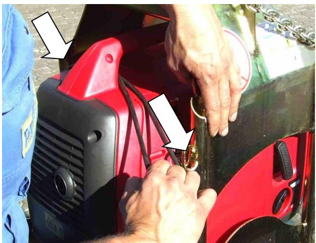
10. Korrekte Sicherung des Stromerzeugers mit Gummiband (↙ ↘)
