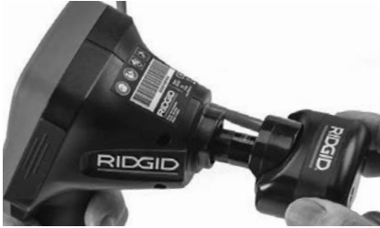
18. ábra – Kamera csatlakozódugója beszerelt állapotban
