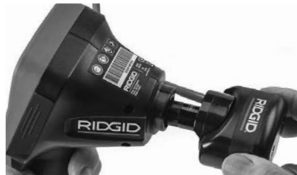
Figuur 18 – Cameraverbindingsstekker geïnstalleerd
