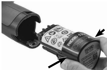
Obrázek 5 – Vymutí a instalace baterie
