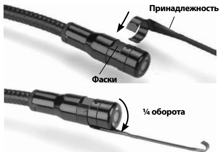
Рис. 8 - Установка принадлежности
