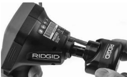
Figura 18 - Fișa conectorului a camerei instalată
